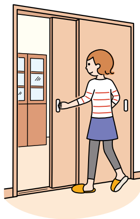
引き戸は大開口でも開閉しやすく、 つえや車いすでの移動も楽
