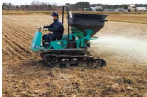
土壌改良材のバラ散布の様子！！
